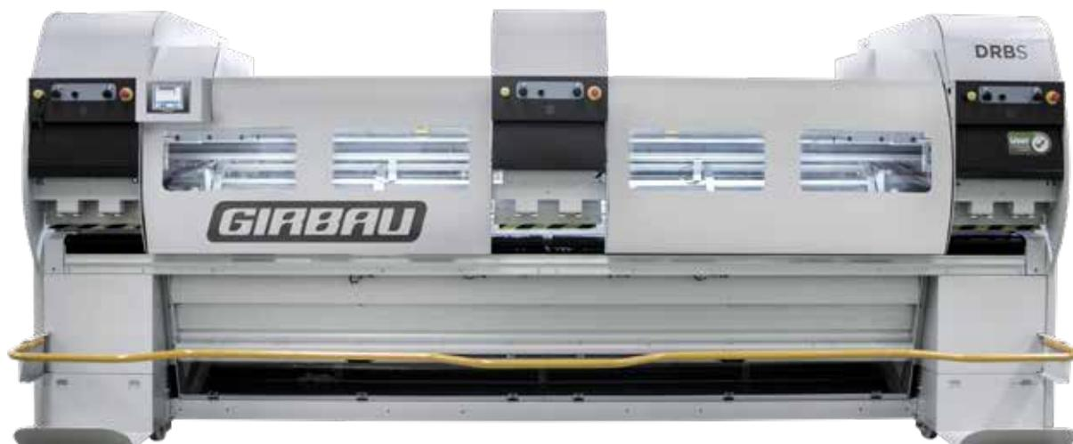
El introductor frontal automático **DRBS** permite introducir diferentes tipos de ropa y dimensiones en 1 ó 2 vías automáticamente y hasta 4 en introducción manual.
