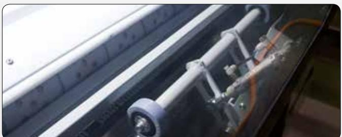
Sistema de rodillos prensores en la introducción para asegurar la correcta carga de la pieza, especialmente si es pesada o deslizante.
