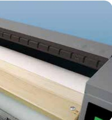
Un système de séparateurs situés à la sortie du linge empêche l'enroulement des articles dans le cylindre.
