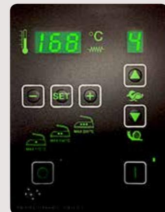
El usuario selecciona electrónicamente la temperatura deseada y regula la velocidad a través de un panel de control.
